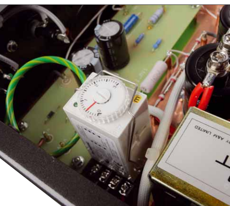
Dieses Relais erledigt die Einschaltverzögerung
